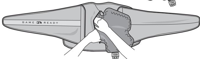
**3** Achten Sie darauf, dass der Wärmetauscher ohne Falten oder Knicke flach in der Bandage steckt. Schließen Sie ggf. den Reißverschluss der Bandage. Drehen Sie die Bandage nach der Montage mit der blauen Seite nach oben und vergewissern Sie sich, dass der Wärmetauscher glatt und gleichmäßig in der Bandage liegt.
