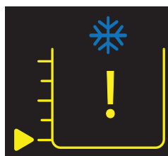
Холодовой резервуар пуст
