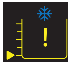
Холодовой резервуар пуст
