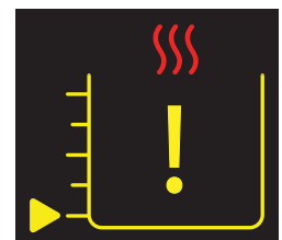
Reservatório quente vazio
