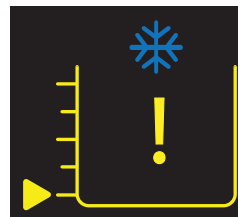
Reservatório frio vazio
