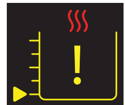
Reservatório quente vazio
