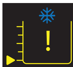
Serbatoio freddo vuoto
