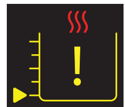
Serbatoio calore vuoto
