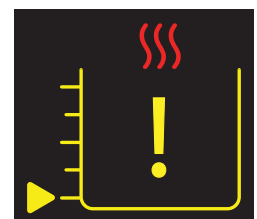
Réservoir chaud vide
