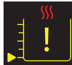
Άδεια δεξαμενή θέρμανσης
