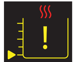
Άδεια δεξαμενή θέρμανσης
